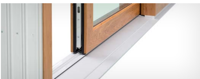
I standardversion finns tre låsande hakar som förbättrar säkerhet. Dessutom kan moderna element som motverkar att lyfta av dörren och garanterar en hög säkerhetsnivå installeras.
